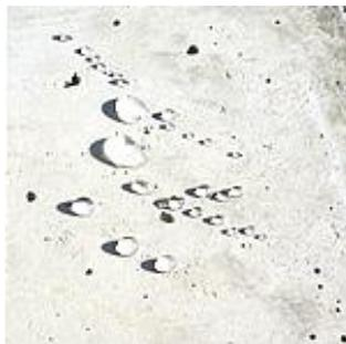
サーファポアを塗布したコンクリートは水を弾き返します。水をかけても、まったく変色しません。素材に水がしみこむのを防ぐことにより、水垢やカビなどの汚れから建築素材を守ります。
