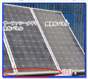
※こちらはキプロスにて、6ヶ月間放置した太陽光パネルの写真です。無塗布パネルには汚れが付着しそのままですが、サーファシールド G を塗布した太陽光パネルの表面には砂や埃汚れは付着せず、滑り落ちているのが見えます。
