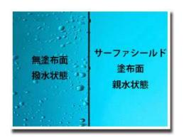
サーファシールド G 塗布面は親水性をもたらされ、水滴はガラス表面に留まることが出来ないため、水は表面を すべり、埃や汚れの下に潜り込むように下へ流れていきます。
